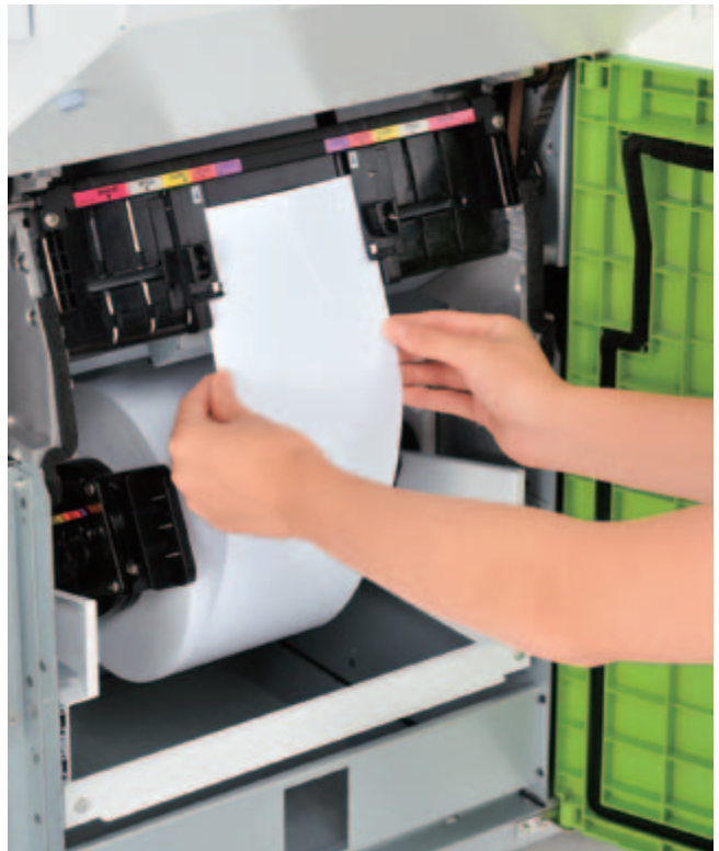
► Leicht zugänglich: Hinter der Fronttür befindet sich die Spindel zur Aufnahme der 100-m-Papierrolle. Abb.: NK Works Co., Ltd.
