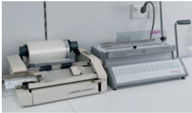
➤ Friedliche Koexistenz: die Einrichtung zum Einschlaufen von Filmmaterial und rechts daneben die Handstanz- und Bindemaschine. Abb.: fe
